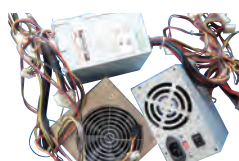
電源ボックス
